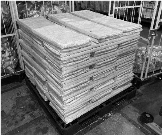
発砲スチロールの圧縮減容 リサイクル業者の指定の大きさに
